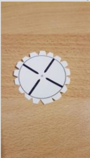
Aus der dünnen Pappe schneidet man ebenfalls einen Kreis mit dem Durchmesser der Pappröhre heraus. Den ersten Kreis mit dem 2 mm Kreis in der Mitte klebt man nun deckungsgleich auf den Pappkreis. Jetzt muss noch mit dem Taschenmesser der kleine 2 mm Kreis ausgeschnitten werden. Er dient später dazu einen Teil des Sonnenlichtes auf das Fadenkreuz am anderen Ende der Röhre zu projizieren. Die Pappröhre wird nun noch auf die gewünschte Länge gekürzt. In meinem Fall sind das 30cm.
