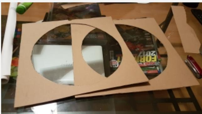
Um den Filter nun zu bauen benötigt man ein bisschen Pappe, Pack-Klebeband, doppelseitiges Klebeband und einen Tacker. Aus der Pappe schneidet man als erstes zwei gleich große Quadrate oder Ringe aus. Der Innendurchmesser sollte der Öffnung des Teleskopes entsprechen und der Außendurchmesser mind. 2cm größer
