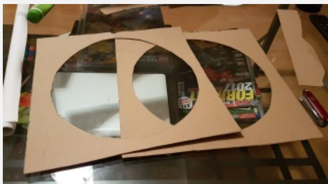
Um den Filter nun zu bauen benötigt man ein bisschen Pappe, Pack-Klebeband, doppelseitiges Klebeband und einen Tacker. Aus der Pappe schneidet man als erstes zwei gleich große Quadrate oder Ringe aus. Der Innendurchmesser sollte der Öffnung des Teleskopes entsprechen und der Außendurchmesser mind. 2cm größer
