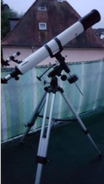
Der Refraktor von Teleskopexpress ist das Teleskop von meinem Sohn. Es hat eine Öffnung von 70mm und eine Brennweite von 900mm.
