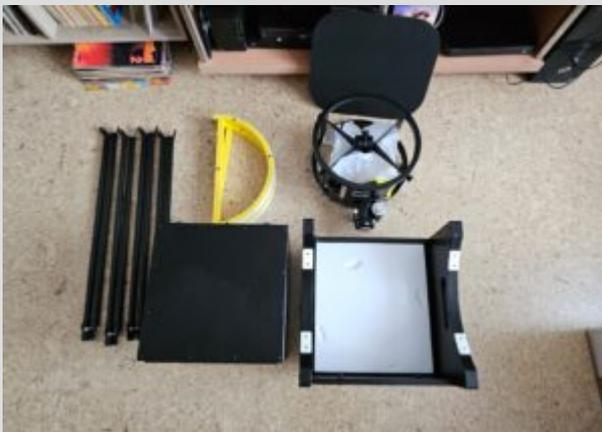
Am Mittwoch wurde das Teleskop dann geliefert. Ich habe zunächst alles ausgepackt und nebeneinander auf den Boden gelegt. Dank der Aluminiumkonstruktion ist das Teleskop erstaunlich leicht und kompakt. Der Aufbau ist nahezu werkzeuglos möglich - lediglich zwei der sechs Schrauben der Höhenräder müssen mit dem beiliegenden Inbusschlüssel befestigt werden. Den Erstaufbau hatte ich nach etwa zehn Minuten abgeschlossen.
